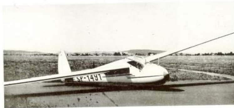
PLANEUR MONOPLACE "MUCHA" "MOUCHE 100" Le plus moderne et le plus robuste des planeurs-école polonais
